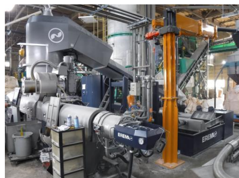
【 二日市 RC 設備入替 (左:脱水設備・右:造粒機) 】
