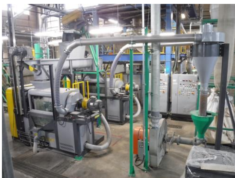
【 二日市 RC 設備入替 (左:脱水設備・右:造粒機) 】
